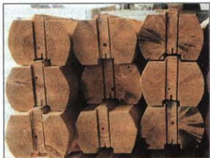
На торцах брёвен видно изменение окраски под действием деревоокрашивающих грибов.
