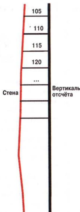
Подгонка плиты к неровной стене.
